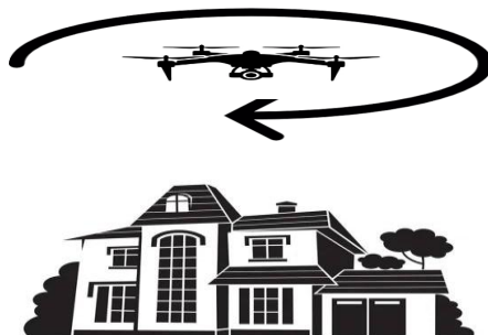
Рис. 2. Схема съемки методом «достопримечательность»
