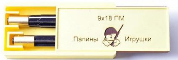
Рис № 3. Набор развёрток для изготовления патронника в бланке ствола калибра 9x18 мм.
