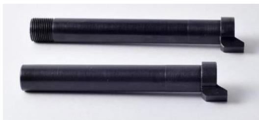
Рис. № 2. Бланки стволов калибра 9x18 мм для списанного и охолощенного оружия, изготовленного на базе пистолета Макарова. Верхний ствол имеет наружную резьбу для присоединения глушителя.
