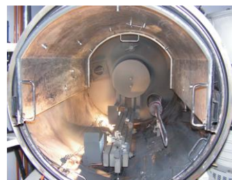
Рис. № 8. Внутреннее пространство большой вакуумной камеры с открытым люком
